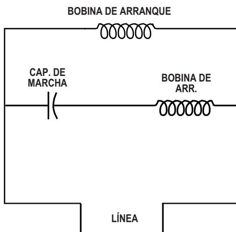
Este tipo de motor es un motor de fase dividida equipado con un capacitor de marcha en serie con la bobina de arranque. No se utiliza el interruptor de arranque, por lo que el capacitor y la bobina de arranque siempre están en el circuito. El motor está construido de tal manera que permite esto sin quemar la bobina de arranque. Un motor PSC tiene una torsión de arranque baja, pero es muy efectivo en la operación y generalmente cuesta menos que un capacitor de arranque y marcha para motor.
