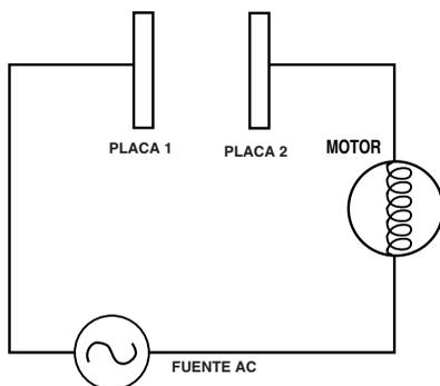
Ahora, vamos a conectar nuestro capacitor a una fuente de corriente AC y en serie con el embobinado de un motor eléctrico. Puesto que la corriente AC alterna, primero una placa entonces, después la otra se carga y descarga a su vez.
