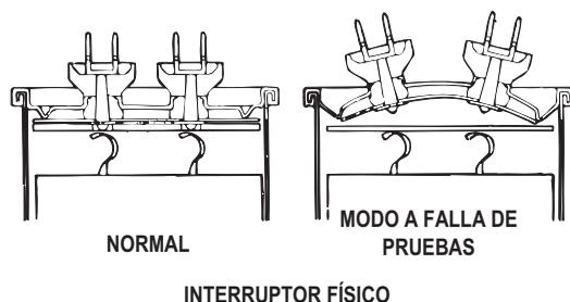
Cuando aumenta la presión dentro del capacitor, la parte superior se revienta, rompiendo la conexión entre las terminales y las placas.
