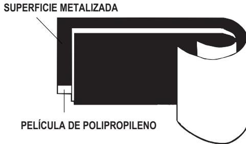
En lugar de utilizar hojas de aluminio separadas por varias capas de papel para crear las placas y el aislante, los capacitores metalizados utilizan hojas de película de polipropileno a las cuales se aplica una capa delgada de metal por medio de aspersión. Después se enrollan dos películas metalizadas juntas muy apretadas para formar el capacitor.
