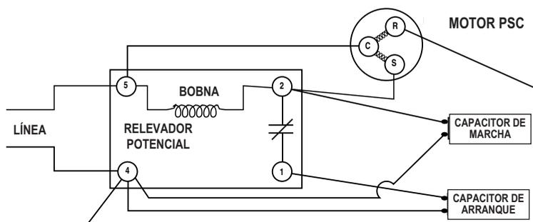
Recientemente, el desarrollo de los PTCR han reemplazado al equipo de arranque fuerte en ciertas aplicaciones. El arranque de estado sólido PTCR se conecta en paralelo con el capacitor de marcha del motor PSC y produce el efecto adicional de “fuera de fase” que ofrecía anteriormente el relevador y capacitor. Aunque es más económico y más fácil de instalar, el PTCR no produce tanto efecto como el equipo de arranque fuerte tradicional, de manera que su uso se ha limitado a motores mas pequeños.
