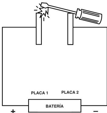
Si hiciéramos corto en las placas con un desarmador, la chispa nos indicaría el "puente" de electrones de la placa 2 a la placa 1 para igualarla. Al retirar el desarmador, la placa 2 vuelve a juntar la carga.
