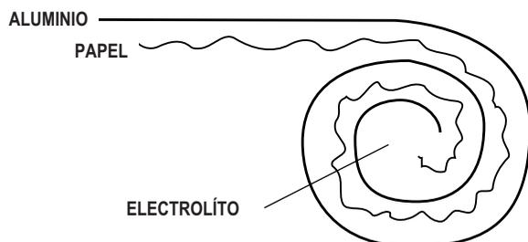
Los capacitores están solamente diseñados para trabajo intermitente, no más de 20 arranques por hora, y cada periodo de arranque no deberá tardar más de tres segundos. Los arranques más largos o más frecuentes producen un aumento excesivo de calor dentro del capacitor y causan fallas prematuras.
