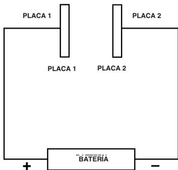
Un capacitor muy sencillo se compone de dos placas separadas por un dieléctrico, en este caso, y conectado a una fuente de corriente DC, una batería. Los electrones salen de la placa 1 y se juntan en la placa 2, dejándola con una gran cantidad de electrones, ó sea "carga". Puesto que la carga de una batería fluye en una sola dirección, la placa del capacitor permanece cargada, a menos que haya algo que produzca flujo de corriente.
