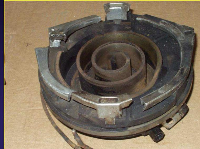
**La lubricación se ve comprometida por el exceso de temperatura y la cupla se rompe**
