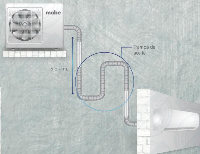
Una trampa de aceite debe ir instalada cada 5 o 7 m si la unidad externa supera 5 m la altura de la unidad interna.
