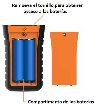
6.2.1 No utilice baterías con especificaciones diferentes a las descritas en este manual (IC18650-2600mAh-3.7V)
